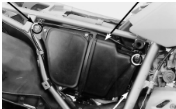
TUBO DE RESPIRO DA CARÇA DO MOTOR
