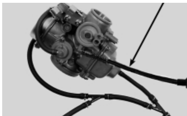
PARAFUSO DE CONTROLE DE ACELERAÇÃO
