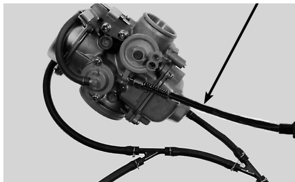
PARAFUSO DE CONTROLE DE ACELERAÇÃO
